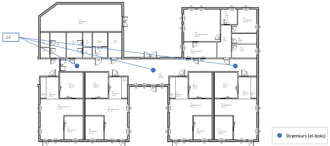
Figur: eksempelskisse som illustrer plassering av repeaters for xComfort nettverk. Rom for IKT-underfordeling, der gateway er plassert, er markert i gult
