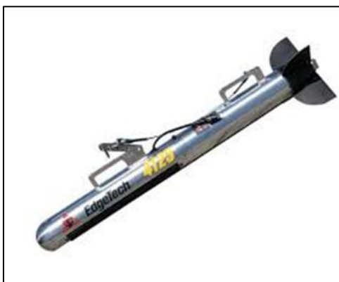
Figur 12. Sonarsystem av EdgeTech-merket (4125).
