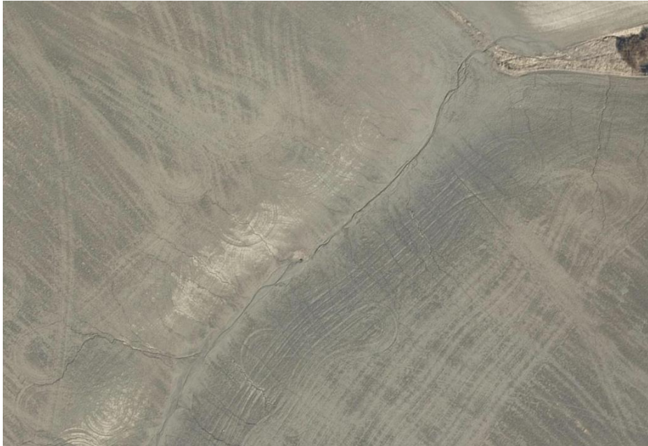
Figur 49. Eksempel på erosjon i dråg på jordet med et hull der det antagelig er skade på det hydrotekniske anlegget. Dette er antagelig feil på rør eller fører til at jord vaskes ned i rørene og ut i bekken. Eksempelet er hentet fra området mellom Skadalsveien, E6 og Jarleveien. Kilde: Finn.no/kart.
