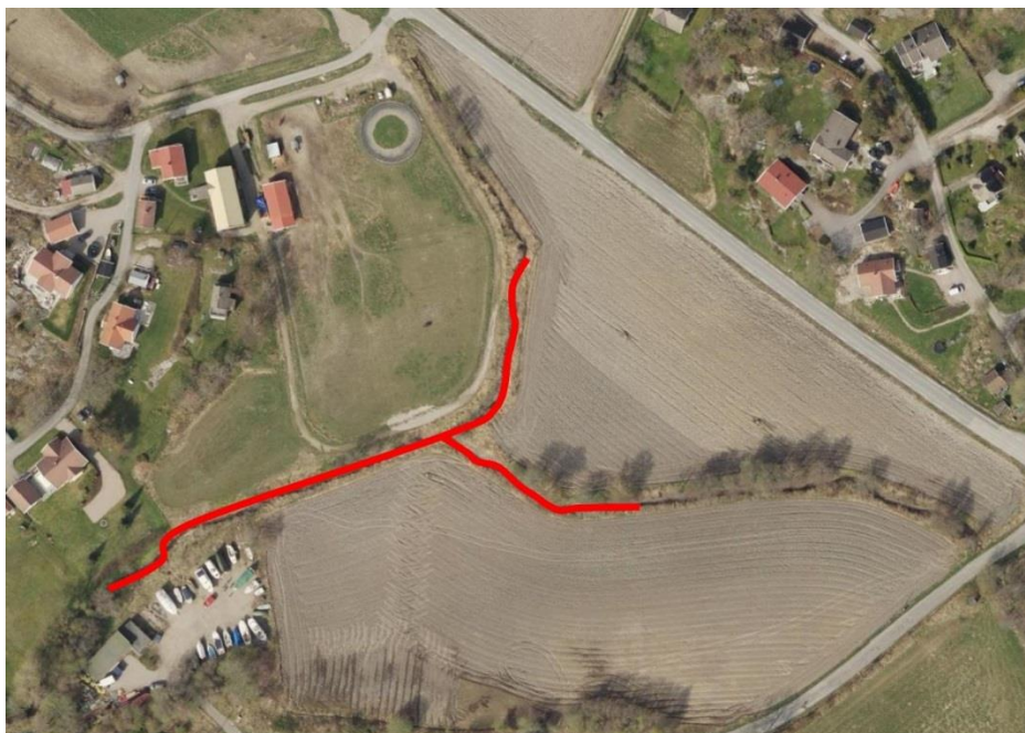
Figur 33. Strekning som opprensning av bekkeløp og senere utlegg av stein- og grussubstrat anbefales utført. Total lengde ca. 280 meter.
