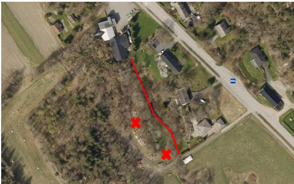
Figur 35. Homogen bekkestreking i Slevikbekkens østre løp egnet for habitattiltak, beliggende mellom Vikaneveien 203 og Vikaneveien 209. Grus og stein kan mellomlagres nær bekken ved markerte kryss, etter avtale med grunneier.
