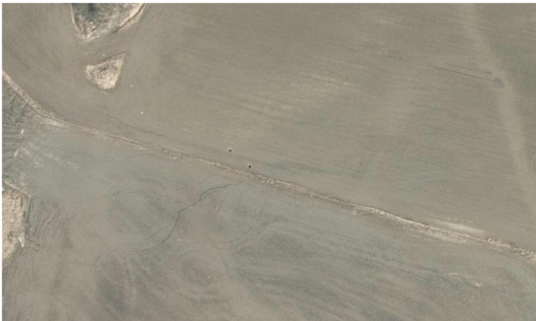
Figur 50. Eksempel på «huller» på jordet. Dette er antagelig feil på rør eller fører til at jord vaskes ned i rørene og ut i bekken. Eksempelet er hentet fra området mellom Skadalsveien, E6 og Jarleveien. Kilde: Finn.no/kart.
